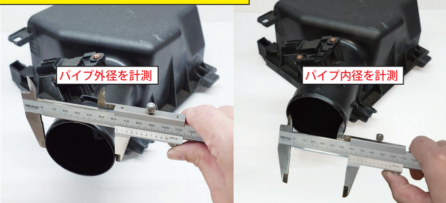
パイプ径の測定、計測場所の写真 (内径・外径)
