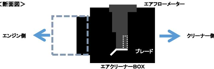
● 取り付け断面図です。作業の参考にして下さい。
