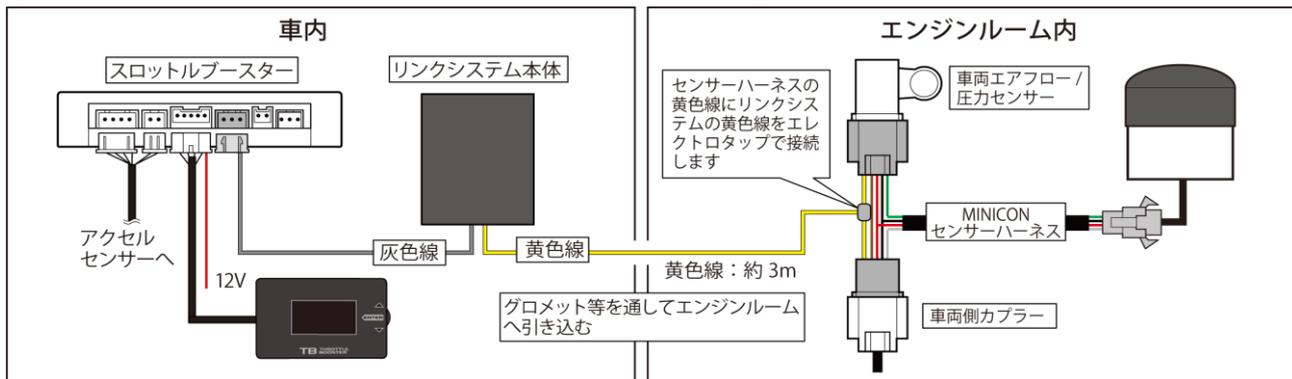
ミニコンまたはミニコンプロを装着している車両のミニコン用センサーハーネスにリンクシステムを接続しスロットルブースターに繋がめます。
